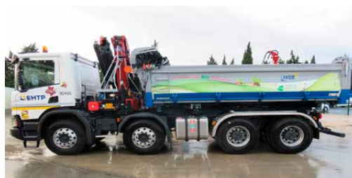
Porteur 8x4 Scania roulant au bioéthanol
